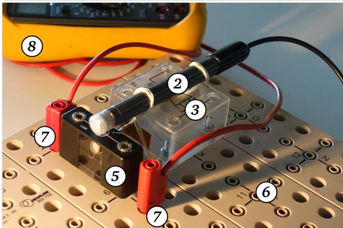
Détail de la fixation de la sonde du luxmètre sur le bloc en plastique
