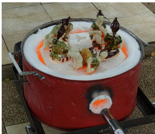
Figure 3.3 – Four à Raku au moment de son ouverture, on observe la couleur jaune orange des parties du four à plus de 1000 °C. Le Raku est une technique d'émaillage
