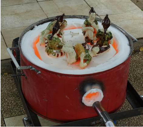
**Figure 3.3** – Four à Raku au moment de son ouverture, on observe la couleur jaune orange des parties du four à plus de 1000 °C. Le Raku est une technique d'émaillage
