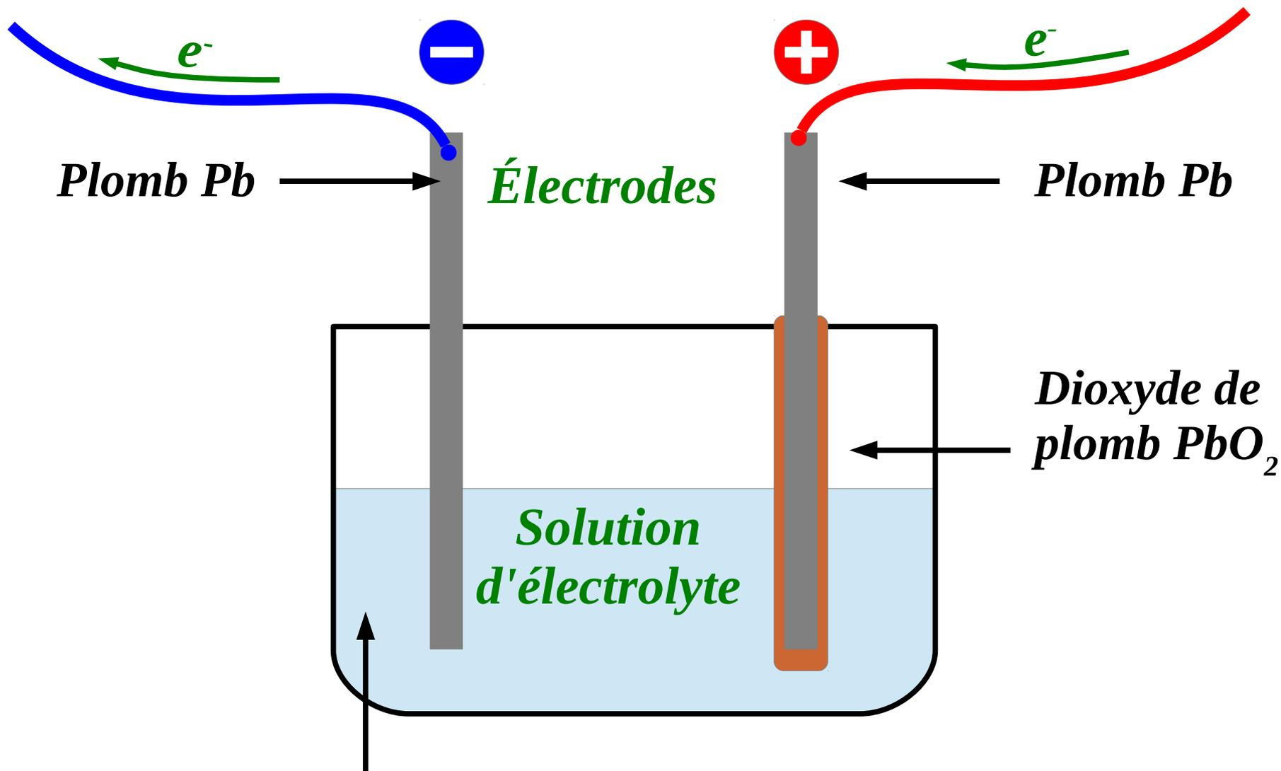
*Solution aqueuse d'acide sulfurique  $H_2SO_4$   $C = 0,1$  à  $6 \text{ mol.L}^{-1}$*
