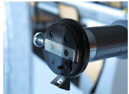
La fente d'entrée du spectromètre doit être fermée presque au maximum, pour avoir une bonne résolution.
