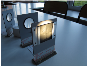
Le collimateur et la fente d'entrée
