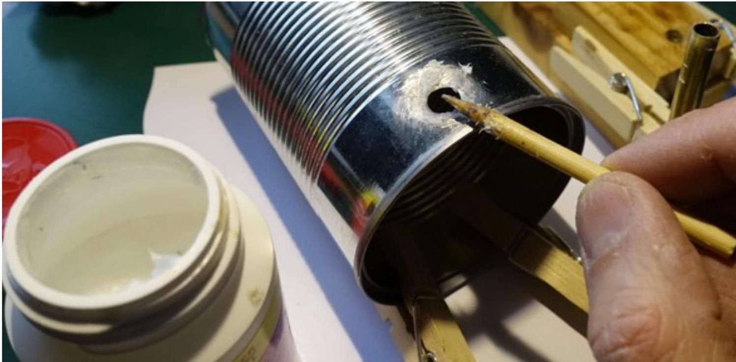
Les zones poncées sont couvertes de pâte décapante qui permettra de plus facilement étamer les pièces métalliques.
