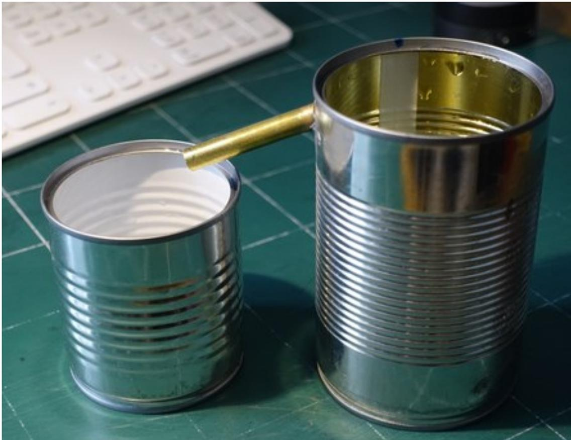
Une cuve à débordement permet de mesurer le volume d'un objet immergé dans la cuve remplie d'eau.
