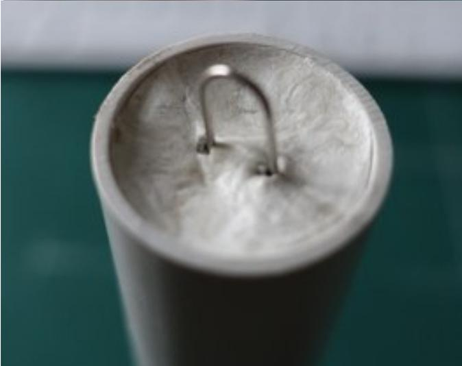
On bouche le tube avec un bloc de pâte à réparer et on y enfonce un trombone à papier pour faire un point de suspension.
