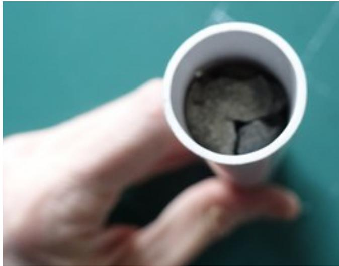
On remplit le tube avec un lest (gravier, sable, pièces métalliques, clous, etc. ...).
